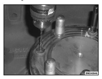
Figure 11. Drilling the Stud
