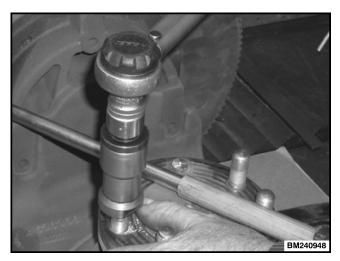
Figure 13. Stud Installation
